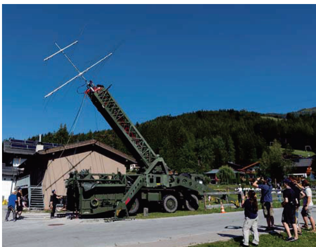
El camión militar MAN 8x8, con su mástil telescópico de 40 m de altura, propiedad del Contest Gruppe Wittgenborn e.V. DP6T.
